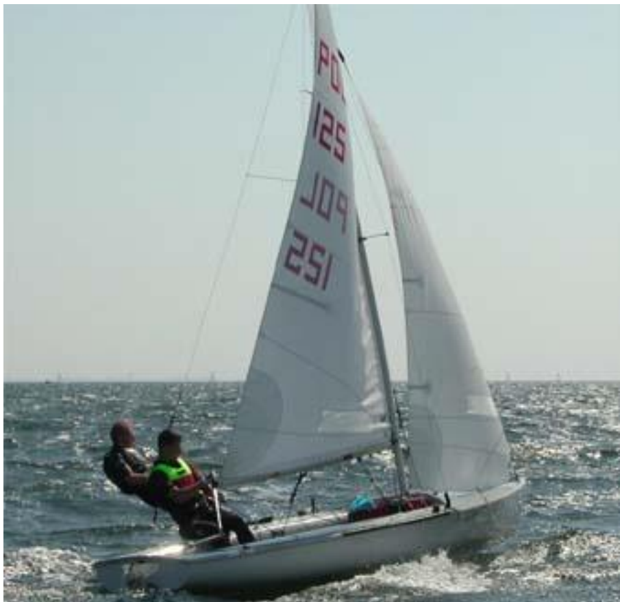
Zdj. 2 Niewłaściwe ustawienie fok powoduje zjawisko nawiewania na grota (backwinding)
