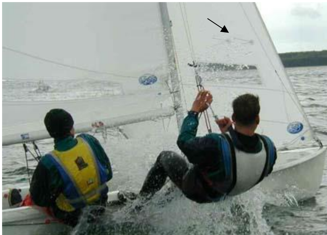
Zdj. 1 Wzrok załogi skierowany na wskaźniki przepływu powietrza (tell-tales) umieszczone na fok.
