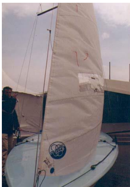
Zdj.4 Niewłaściwa praca regulacją liku przedniego. Nie wybrany lik powoduje pojawienie się zmarszczek i zdeformowanie żagla, a co za tym idzie zwiększenie oporu tarcia.
