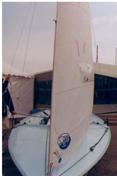
Zdj.3 Prawidłowo wybrany lik przedni żagla powoduje zanik zmarszczek (właściwy kształt) i zmniejszenie oporu tarcia.
